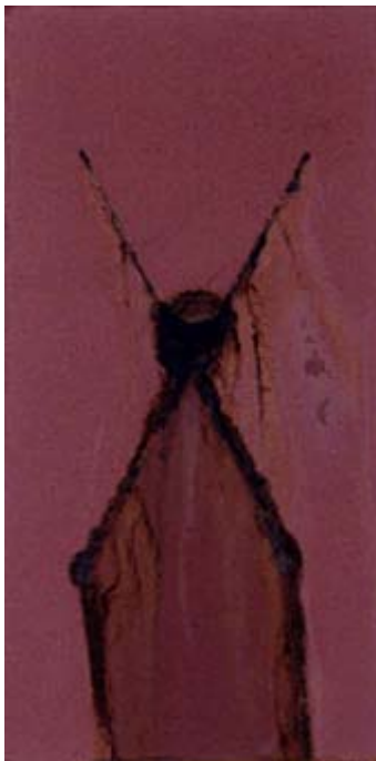
Formula 082101 D Fast Dry Shop Primer VANCOTE W 50 ES 1008 hours
